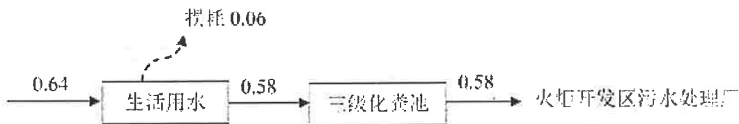
图3-2 项目水平衡图
