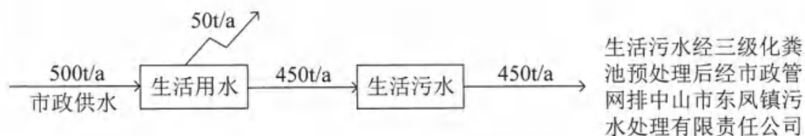
图2-1 项目水平衡图
