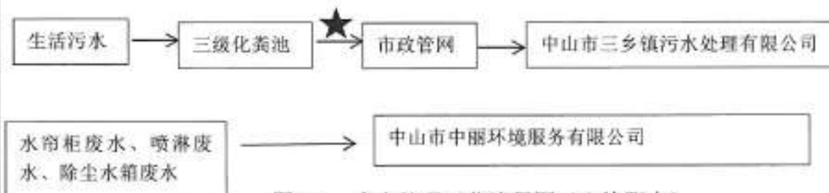
图 3-1 废水处理工艺流程图 (★检测点)
