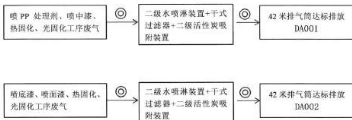
图 3-2 废气处理工艺流程图（⊙ 检测点）
