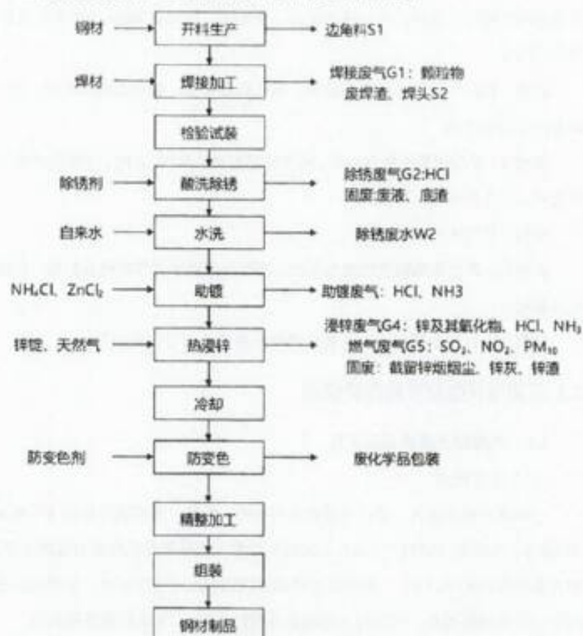
图3-3 三期项目生产工艺流程图及产污节点图
