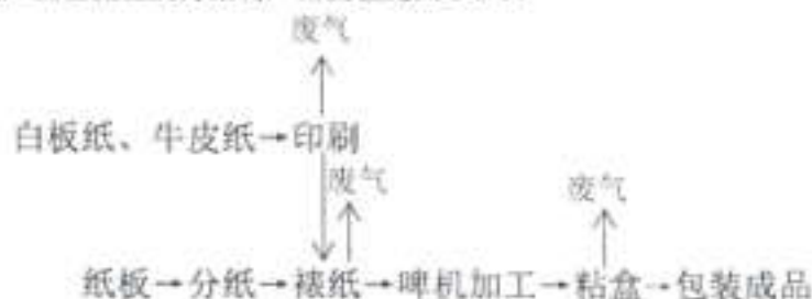
图 2-3-1 项目纸箱生产工艺及污染物产出流程图
