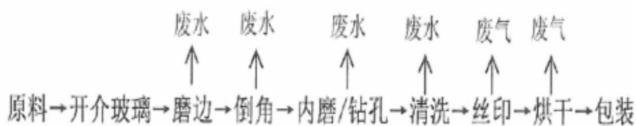
图 2-8 项目生产工艺流程图
