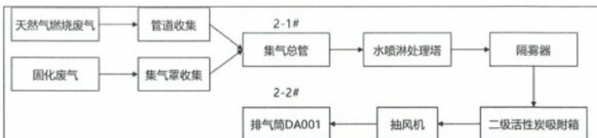
图 3-3 厂房一中喷粉后固化废气及烤炉燃烧尾气处理工艺流程图
