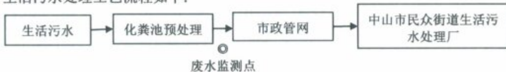
图3-1 生活污水处理工艺流程图
