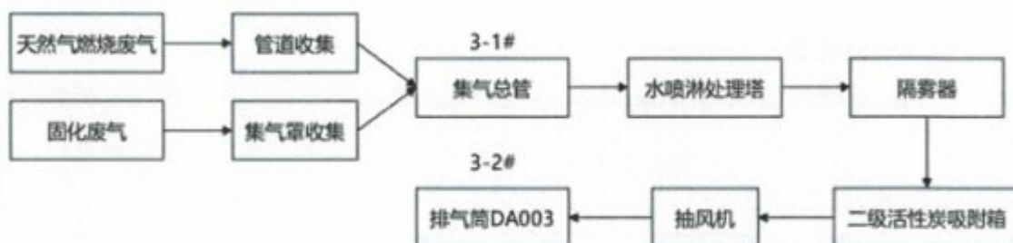
图 3-4 厂房二中喷粉后固化废气及烘干、面包炉燃烧尾气处理工艺流程图
