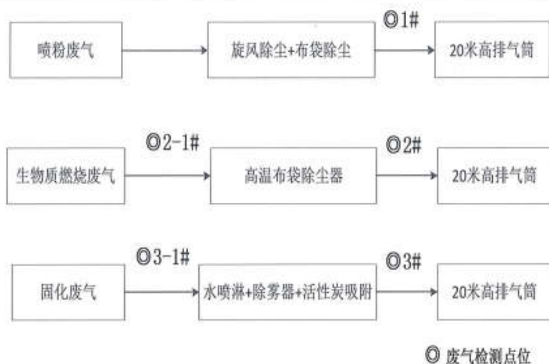
图 3-2 废气处理工艺流程图
