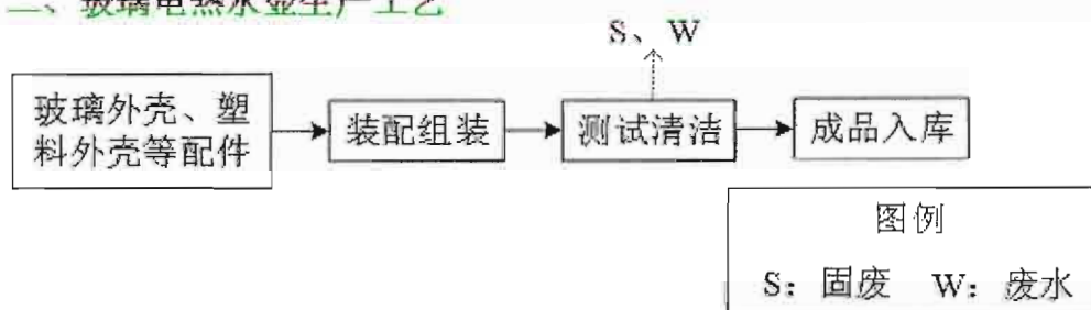
图 2-10 项目生产工艺流程图（玻璃电热水壶）
