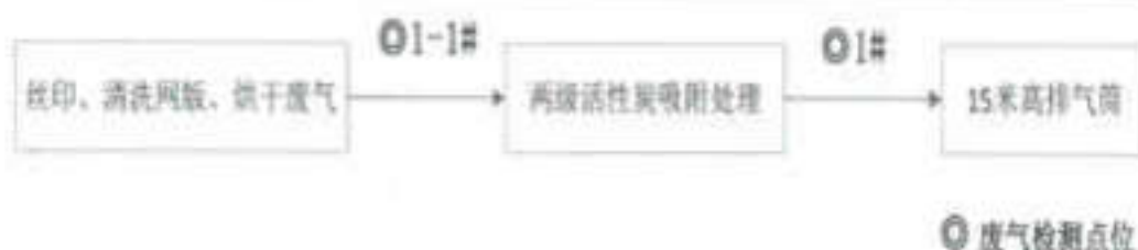
图 3-2 废气处理工艺流程图
