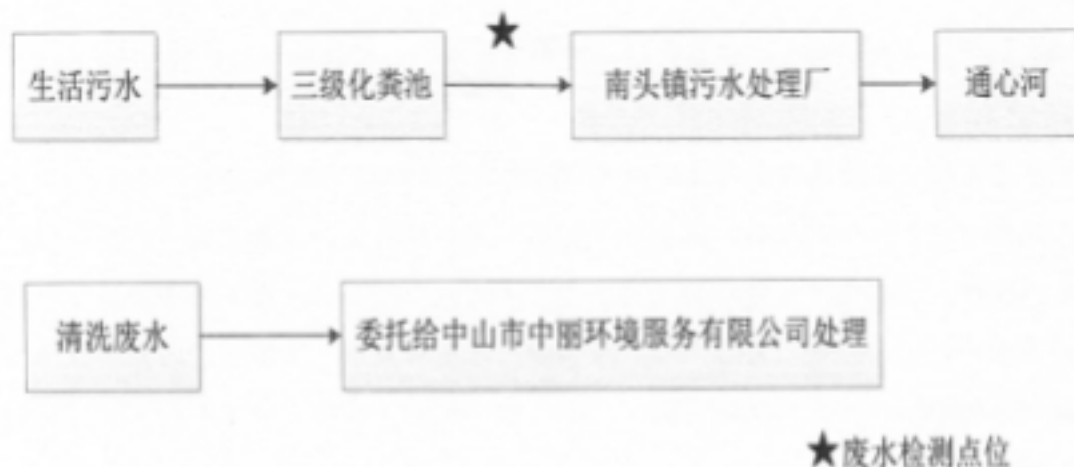
图 3-1 废水处理工艺流程图
