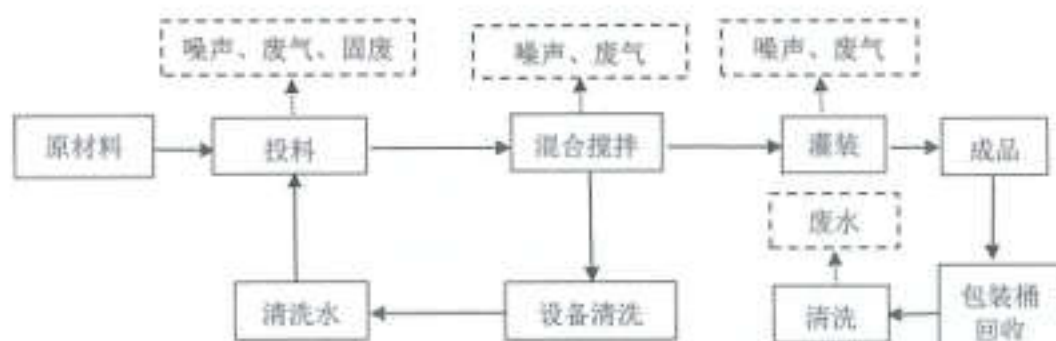
图 2-3 盾构泡沫剂生产工艺流程图
